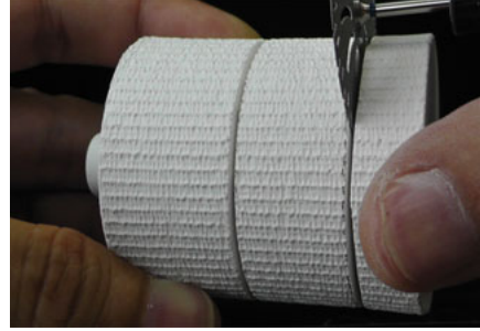
الشكل ١٧: بدء نزع المسحوق الكاسي عن الجسر الخزفي بعد الانتهاء من عملية صب الخزف.
